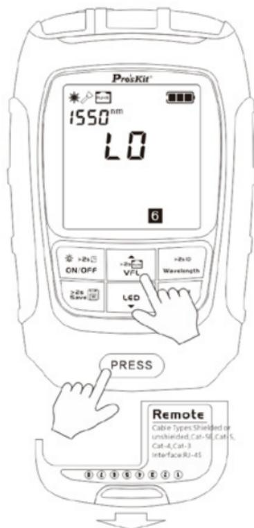
Presione la tecla «PRESS» para extraer el módulo remoto y comprobar el cable de red. Conecte un extremo del cable a comprobar al módulo remoto y el otro a la unidad principal.
