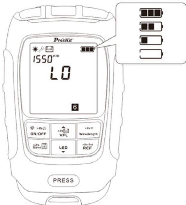
El dispositivo tiene un indicador del estado de la batería. Cuando la energía de la batería es inferior al 20%, debe apagar el dispositivo y recargarlo cuanto antes. El mantener la batería con baja tensión durante un largo tiempo acortará su vida útil.
