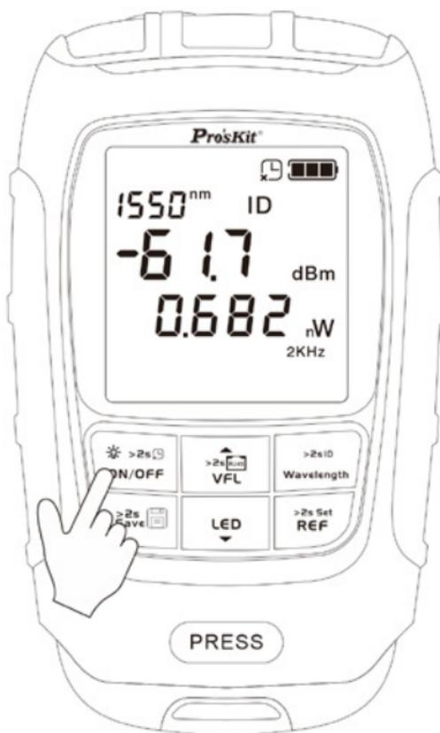
Para encender el dispositivo, presione brevemente " >2s ON/OFF "
